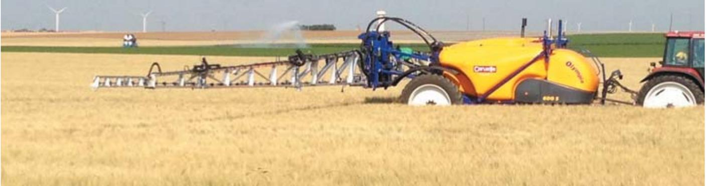
La pulvérisation agricole consiste à protéger et à permettre d'améliorer les rendements des cultures en mettant la bonne dose de produit, au bon endroit et au bon moment.
